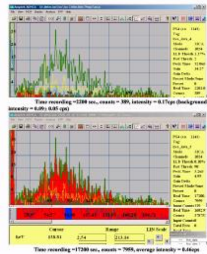
Рис. 13. Рентгеновские и \gamma - спектры W для различных условий во время тлеющего разряда
