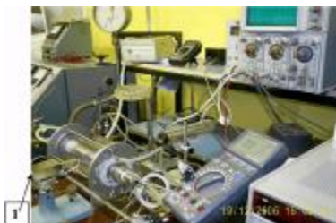
Рис. 9. Фотография установка И.Б. Савватимовой. Цифрой 1 указано расположение детектора рентгеновского излучения [52]
