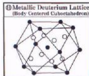
Рис. 21. Формирование конденсированного состояния – кристаллической решетки металлического дейтерия, имеющей объемно-центрированную кубооктаэдральную структуру ( 14 = 8 + 6 поверхностей). Черный круг (●) соответствует грани октаэдра. На каждой такой грани может находиться от 1 до 4 атомов дейтерия (этот случай мы назовем окта-сосудом). Грани тетраэдра обозначены белыми кругами (○). Каждая грань такого тетра-сосуда может принять не более 1 атома дейтерия, и удерживает его там с трудом. См. фото на рис. 11.
