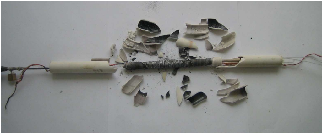
Рис. 9. Расколотая внешняя трубка.
