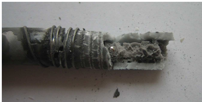
Рис. 10. Расколота внутренняя трубка.
