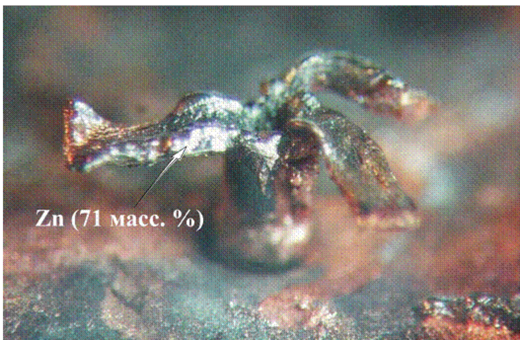
Рис. 7-2. Медная мишень после эксперимента со следами застывшей серебристо-белой «лавы» на её лепестках, вылившейся из центра взорвавшейся мишени (иллюстрация из [Адаменко 2004]).
