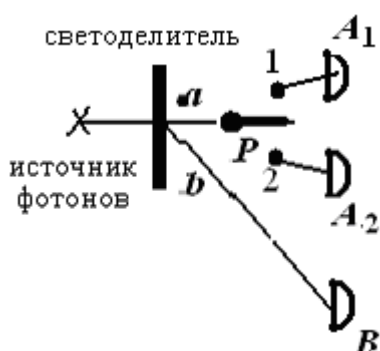
Рис. 1. Фотон a в зависимости от положения переключателя P (1 или 2) поступает на детектор A_1 или A_2 . Фотон b поступает на детектор B .
